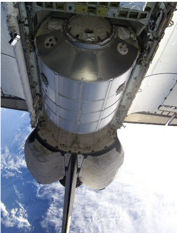
Das Europäische Vielzweck-Logistik-Modul 'Leonardo' im Laderaum der Discovery während der STS-102 Mission. 10. März 2001. (Foto: NASA)
