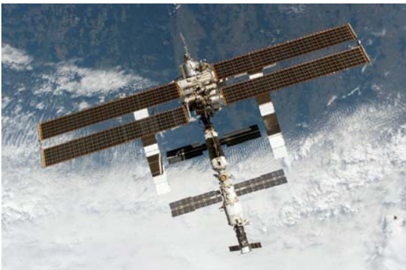
Foto der ISS während der STS-114 Mission am 6 August 2005. Die Solarkollektoren sind als schräg von links nach rechts reichende Strukturen zu erkennen. Zwei Radiatoren-Paneele als Teil des Temperaturkontrollsystems sind rechtwinklig unterhalb des oberen großen Solarkollektors zu sehen. (Image: NASA)
