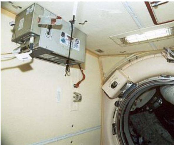
AST/Sileye-3 Detektor für kosmische Strahlung. Hier abgebildet im Pirs Module der ISS.
