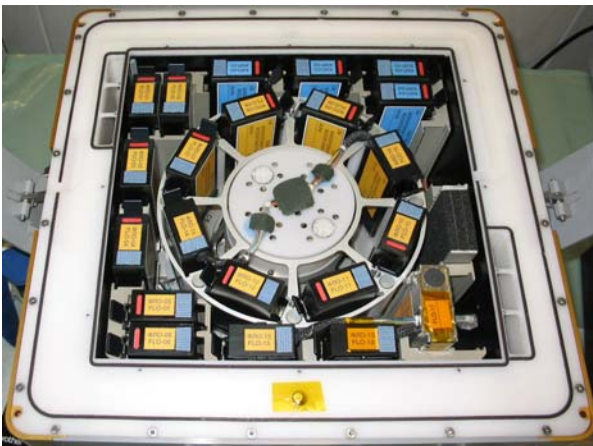
Beispiel wie der Kubik Inkubator - hier in der Konfiguration mit der Zentrifuge - mit Experimentbehältern beladen wird. (Photo: ESA)
