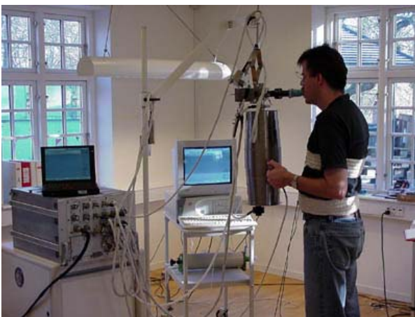
Die von der ESA entwickelten PFM/PAM-Einheiten für das Pulmonary Function System (Lungenfunktionssystem) im Betrieb.
