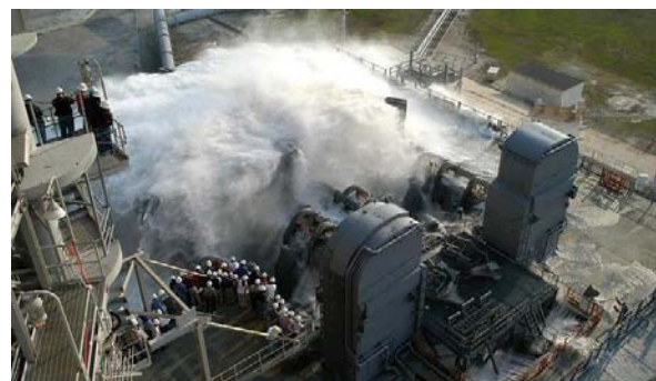
Test des Schalldämpfungssystems am Startplatz 39A des Kennedy Space Center. (Foto: NASA)
