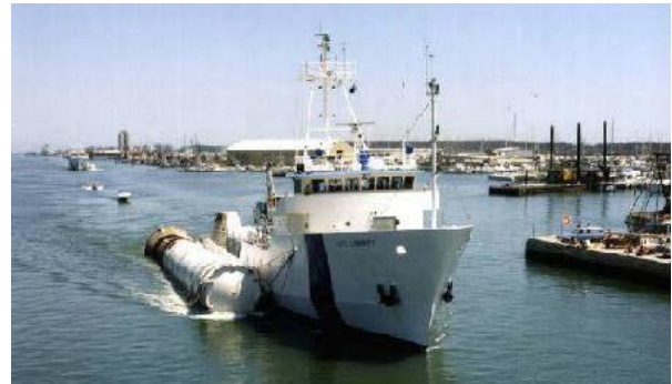
Bergungsschiff beim Einholen der Feststofftriebwerksgehäuse. (Foto: NASA)
