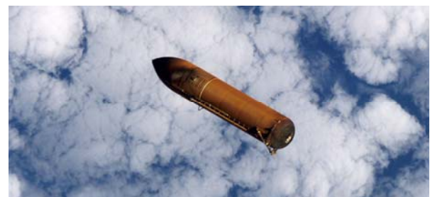
Außentank der STS-114 Wiederflug-Mission nach der Absprengung. (Foto: NASA)
