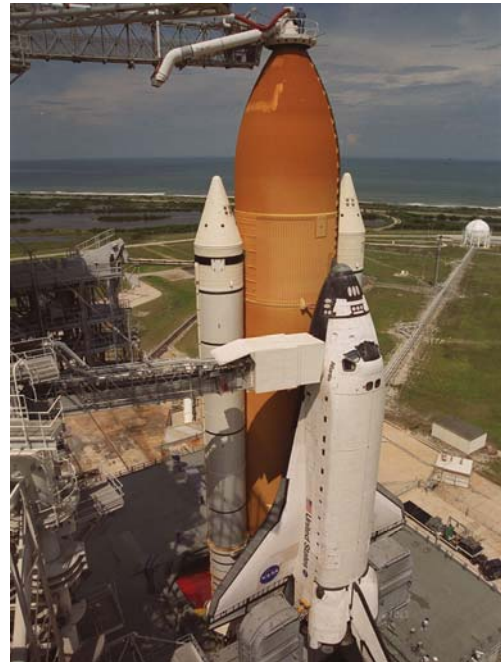
STS-106 auf dem Startplatz. Der „White Room“ ist am Ende des Zugangsarms am Orbiter befestigt. Die „Beanie-Kappe“ an der Spitze des Außentanks vor ihrer Entfernung. (Foto: NASA)
