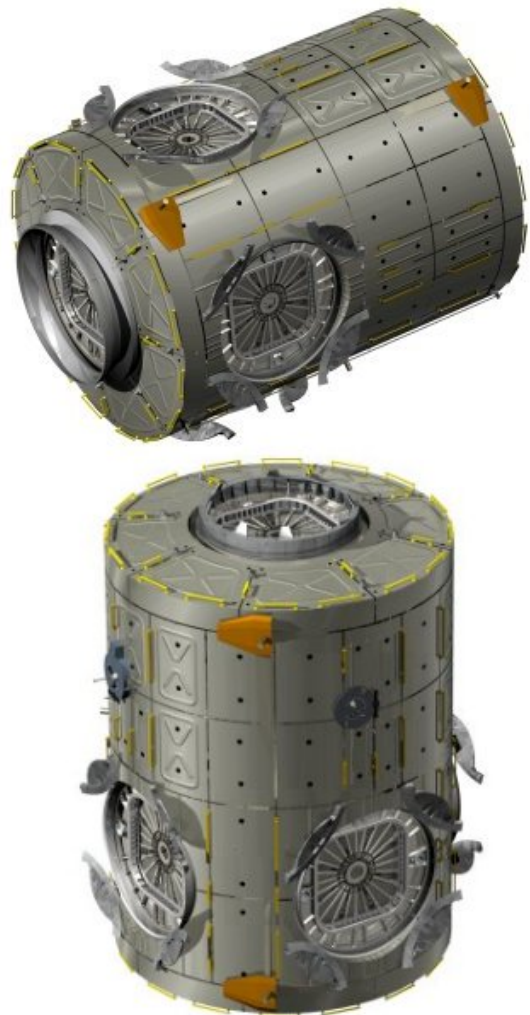
Die von ESA entwickelten Knoten: Knoten 2 (oben), an dem das Columbus-Labor befestigt wird und Knoten 3 (unten), an dem die Kuppel befestigt wird. (Zeichnung: ESA/D.Ducros)
