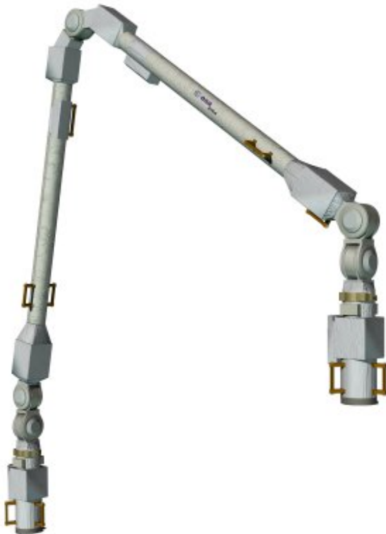
Der europäische Roboterarm (ERA). (Zeichnung: ESA/D. Ducros)
