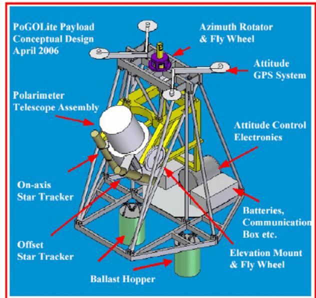
Figure 3: PoGOLite payload
